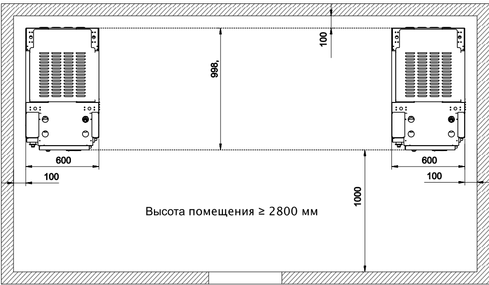
Однорядная установка (вид сверху) для распределительного устройства
